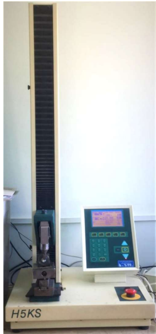
شکل ۳- ماشین تست یونیورسال برای اندازه گیری استحکام باند برشی بین کامپوزیت جدید و قدیم
